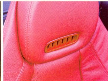
Mercedes-vinging: airscarf , die warme lucht als 'n sjaal om je nek geleidt. Het duurt even voor je wijs wordt uit de knoppenwirwar op de middenconsole.
